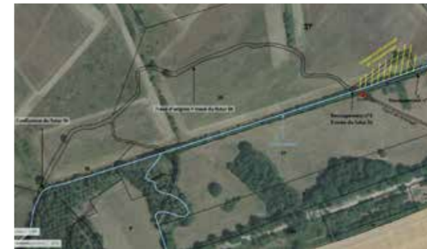
Travaux menés par le Syndicat Mixte d'Aménagement de la Voire : reprise de l'ancien tracé sur 700 m pour remobilisation d'une ZEC de 5 ha déconnectée suite aux anciens travaux de rectification et de recalibrage du lit mineur.
