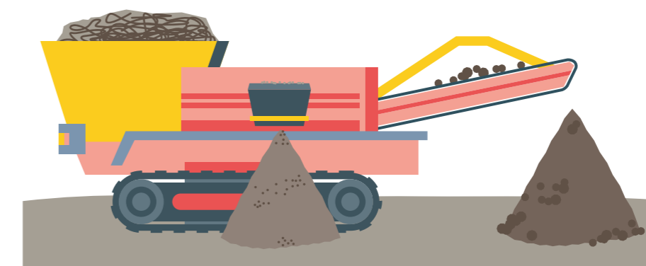
2 L'étape du criblage-concassage est réalisée jusqu'à obtention d'une terre ne contenant plus de rhizomes actifs. Elle est ensuite remise en place.
